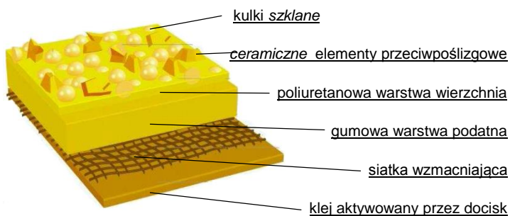
Rysunek 1: Budowa wyrobu A651
